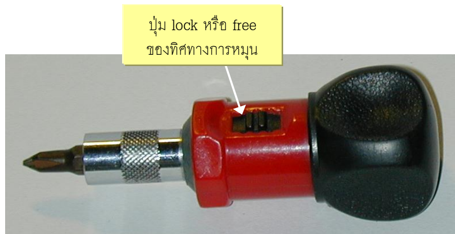
รูปที่ 67 ไขควงเปลี่ยนทิศทางการหมุนและปากขันได้
